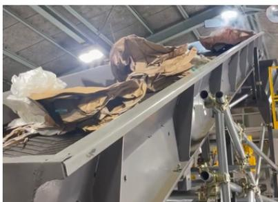
**裁断:** リサイクルされたフレコンバッグを小片に裁断します。
